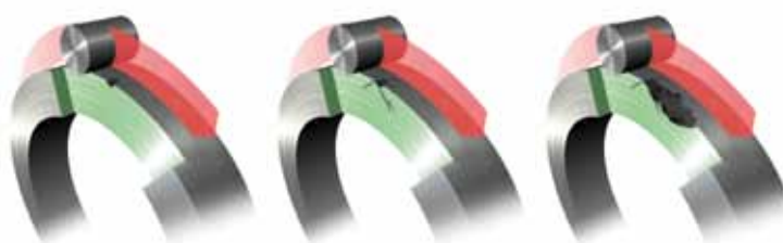
Schadensbildung auf der Oberfläche
